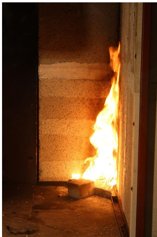
Att. 32 Ugunsreakcijas tests
