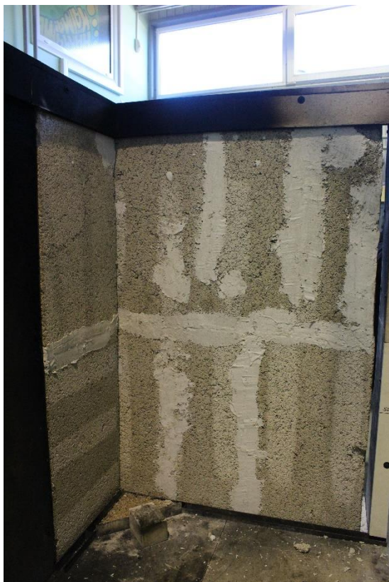
Att. 31 Parauga nostiprināšana iekārtā
