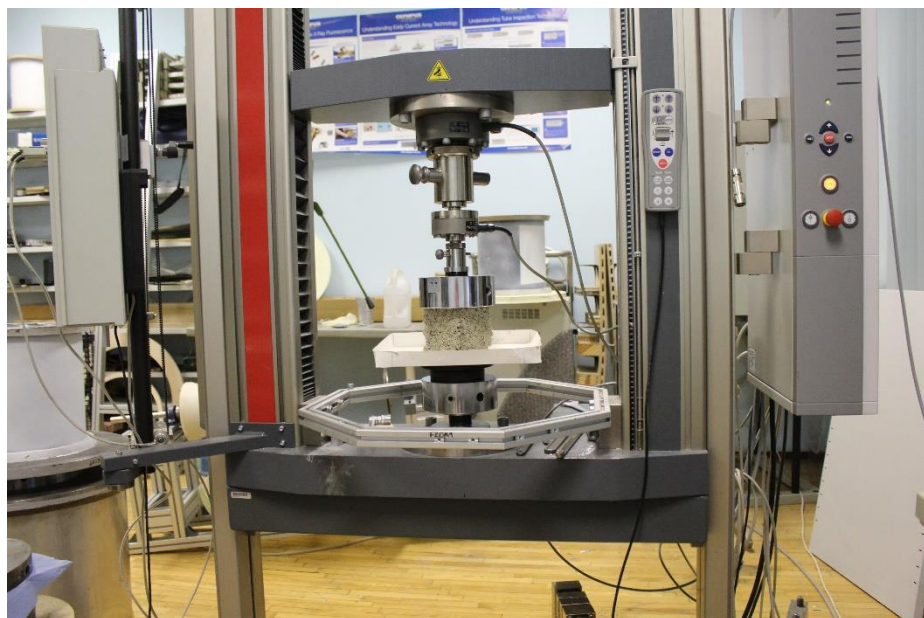
Att. 24 Spiedes testēšana uz Zwick Z100
