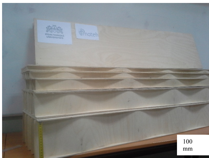
2. attēls Paraugi plātnes ar šūnu tipa dobām ribām lieces nestspējas noteikšanai: Biezums 25 mm; 30 mm; 50 mm; 100 mm un 150 mm.
