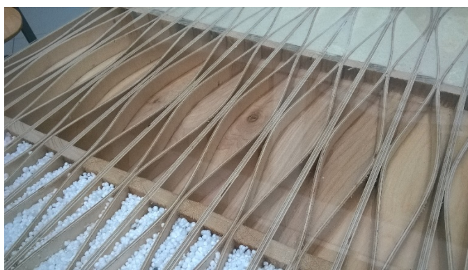
3. attēls. Demonstrācijas paraugs ar pārstrādātu beramo siltumizolāciju, bez siltumizolācijas, ar poliuretāna putu siltumizolāciju.
