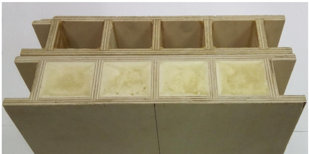
4. attēls. Ribots saplākšņa panelis ar un bez putu komponentes.
