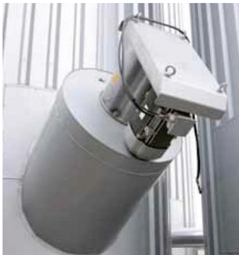
3.att. Maisīšanas ierīce uz bitumena tvertnes ( www.epa.org )
