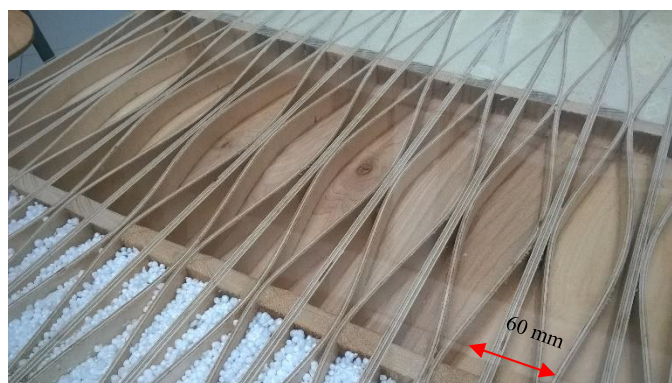
7. attēls. Demonstrācijas paraugs ar pārstrādātu beramo siltumizolāciju, bez siltumizolācijas, ar poliuretāna putu siltumizolāciju
