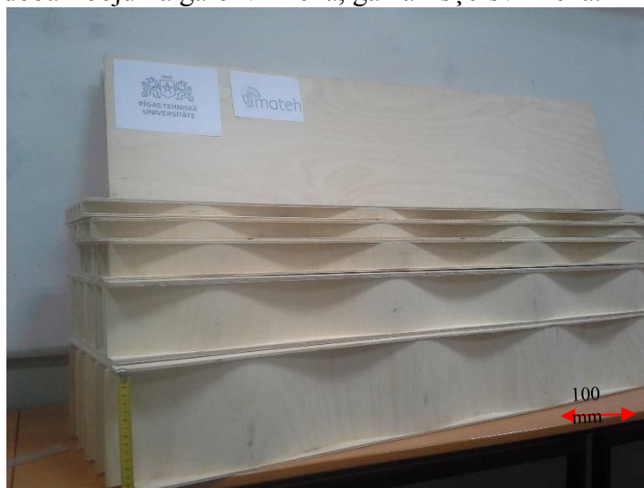
1. attēls Paraugi plātnes ar šūnu tipa dobām ribām lieces nestspējas noteikšanai: Biezums 25 mm; 30 mm; 50 mm; 100 mm un 150 mm.
