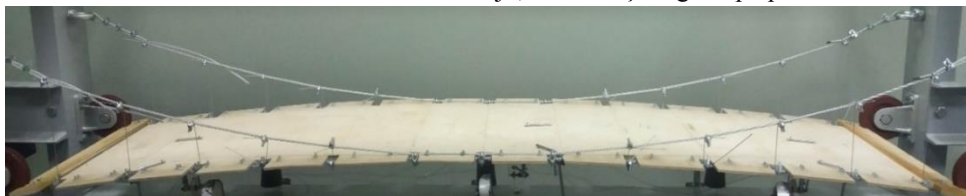
6. attēls. Fiziskais modelis ar klāju, kas uzņem garenpiepūles.
