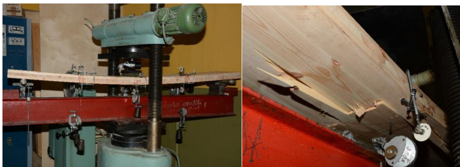
2.attēls. CLT paneļa stāvoklis pirms sabrukuma un sabrukuma aina
