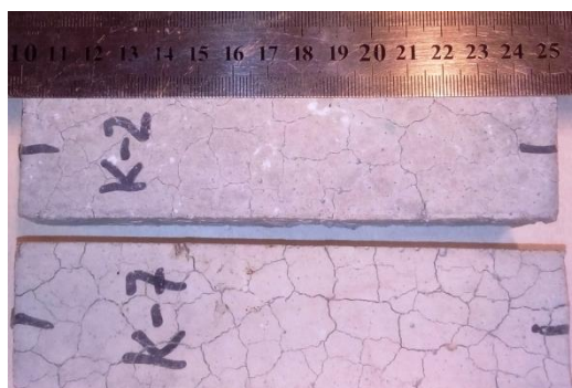
Attēls 1.6. Mikroplaisu tīkls sārma-silīcija reakciju ietekmē paraugiem ar K tipa mikropiedevu.
