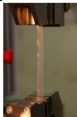
12. attēls. Plēves testēšana stiepē.
