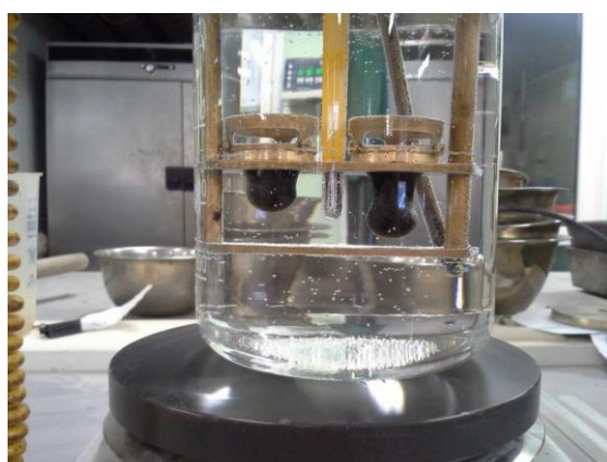
Attēls 2.2. Bitumena mīksttapšanas temperatūras noteikšana.
