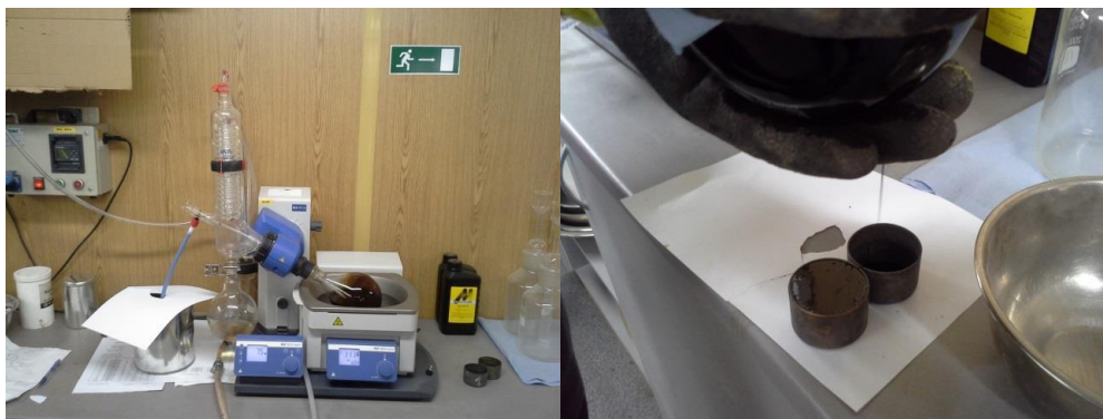
Attēls 2.1. Bitumena atgūšana ar rotācijas tvaicētāju.
