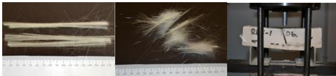
Attēls 1.1. No stikla atsijām sagatavotie stiklašķiedru kūļi, dispersais stiegrojums un izgatavotie paraugi ar kūļveida stiegrojumu stieptajā zonā pēc lieces stiprības pārbaudes.
